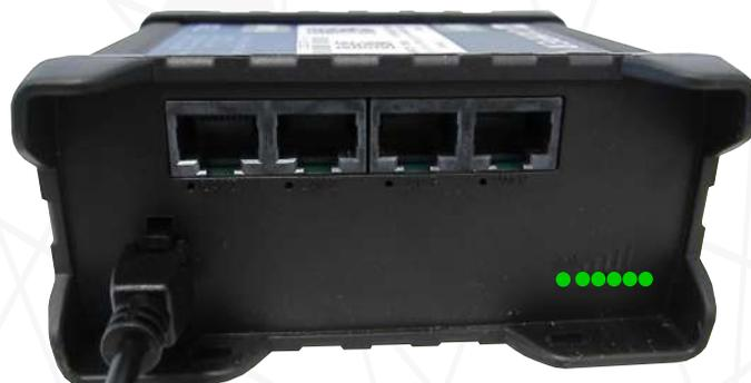
Der Reset wird ausgeführt, wenn alle 5 grünen LEDs der Pegelanzeige leuchten.
