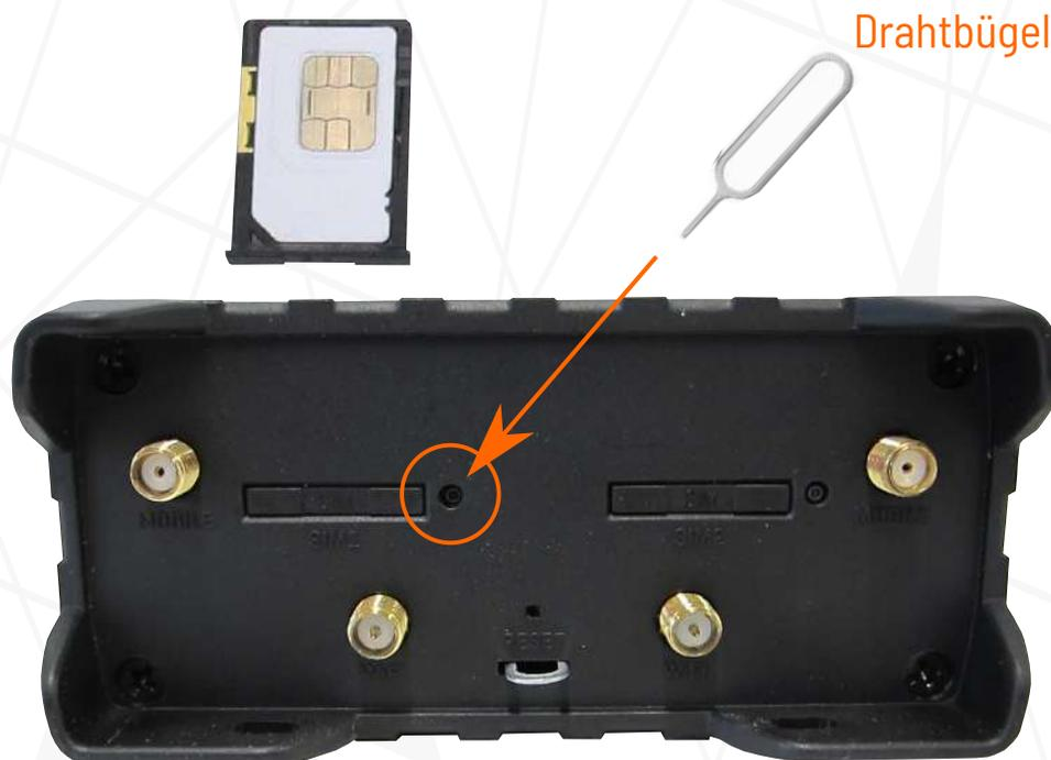
Drahtbügel in den Auswerfer drücken, bis sich das SIM-Fach öffnet.
